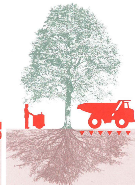
Compactage du sol
